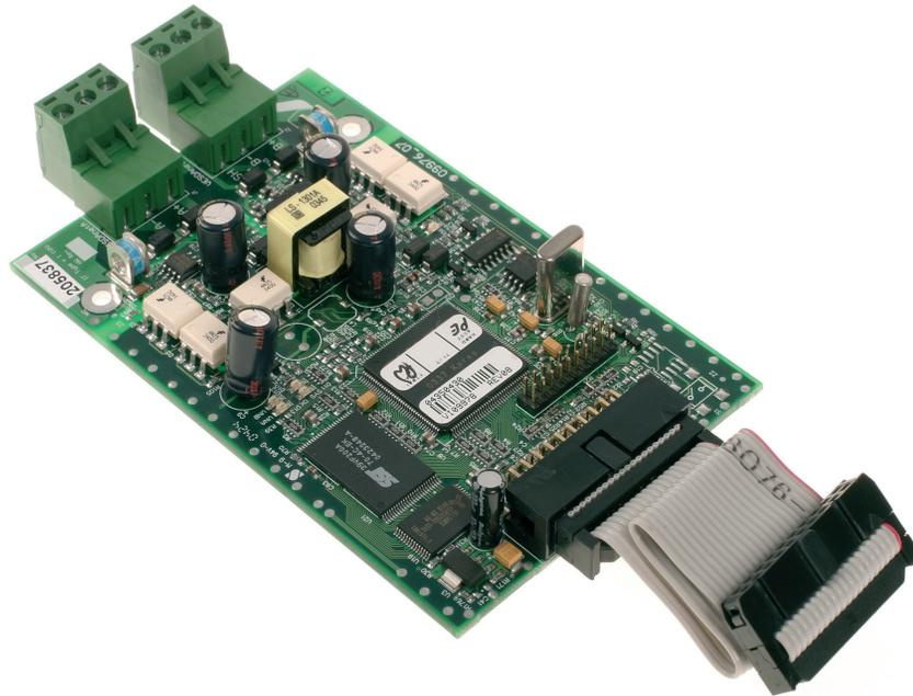
La Tarjeta de Interfaz VESDAnet™ (Tarjeta VN) es una tarjeta de interfaz para la gama de detectores de humo Xtralis VESDA VLF. La Tarjeta VN permite comunicación VESDAnet continua desde el detector a los otros dispositivos VESDAnet, incluyendo las herramientas de supervisión y configuración.
